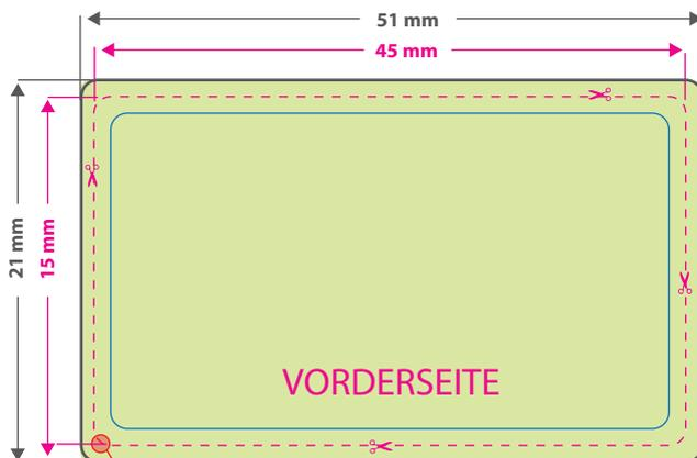
Bitte beachten Sie, dass aus produktionstechnischen Gründen alle Ecken mit einem Radius von 2 mm abgerundet werden.
